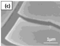
Fig. 4. SEM Images of Ni-W for (a) 60 min, (b) 120 min, (c) 180 min.
